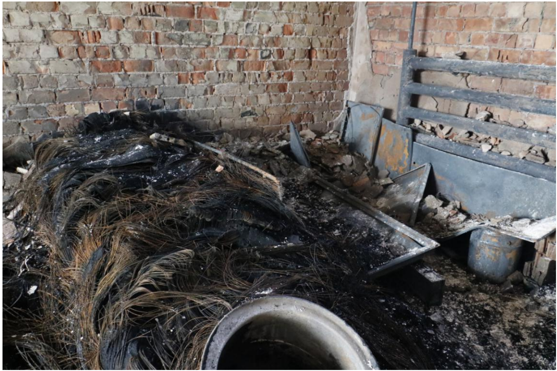
轮胎修理房南侧烧成型的铜丝圆形局部
