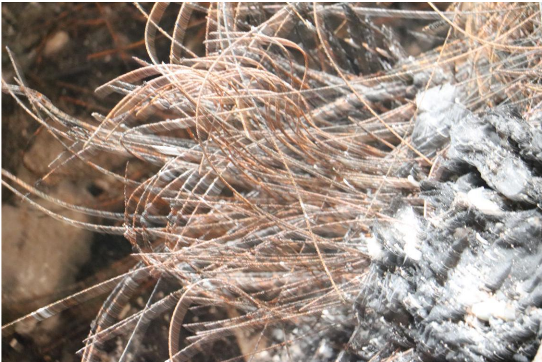
轮胎修理房南侧烧成型的铜丝圆形特写
