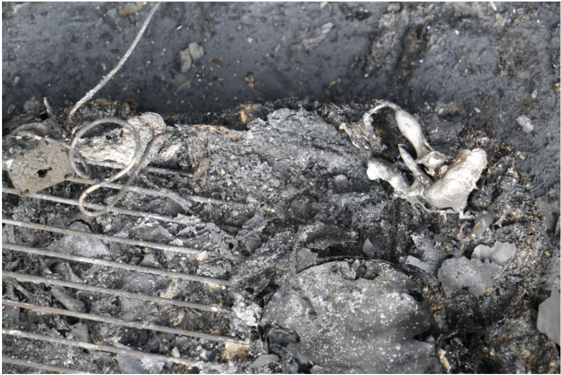
轮胎修理房西南墙角发现的铜制排线管
