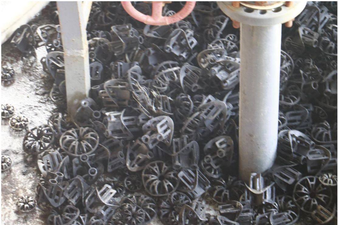
废气过滤塔内部填充物
