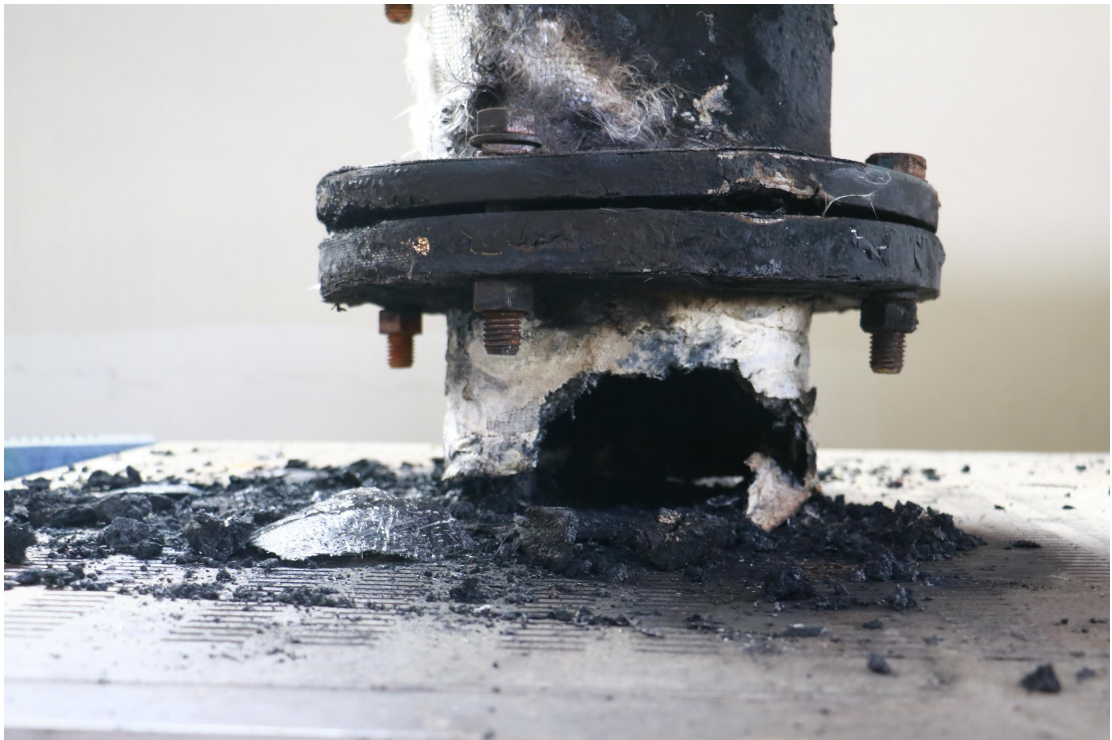
连接马弗炉顶部的玻璃钢管
