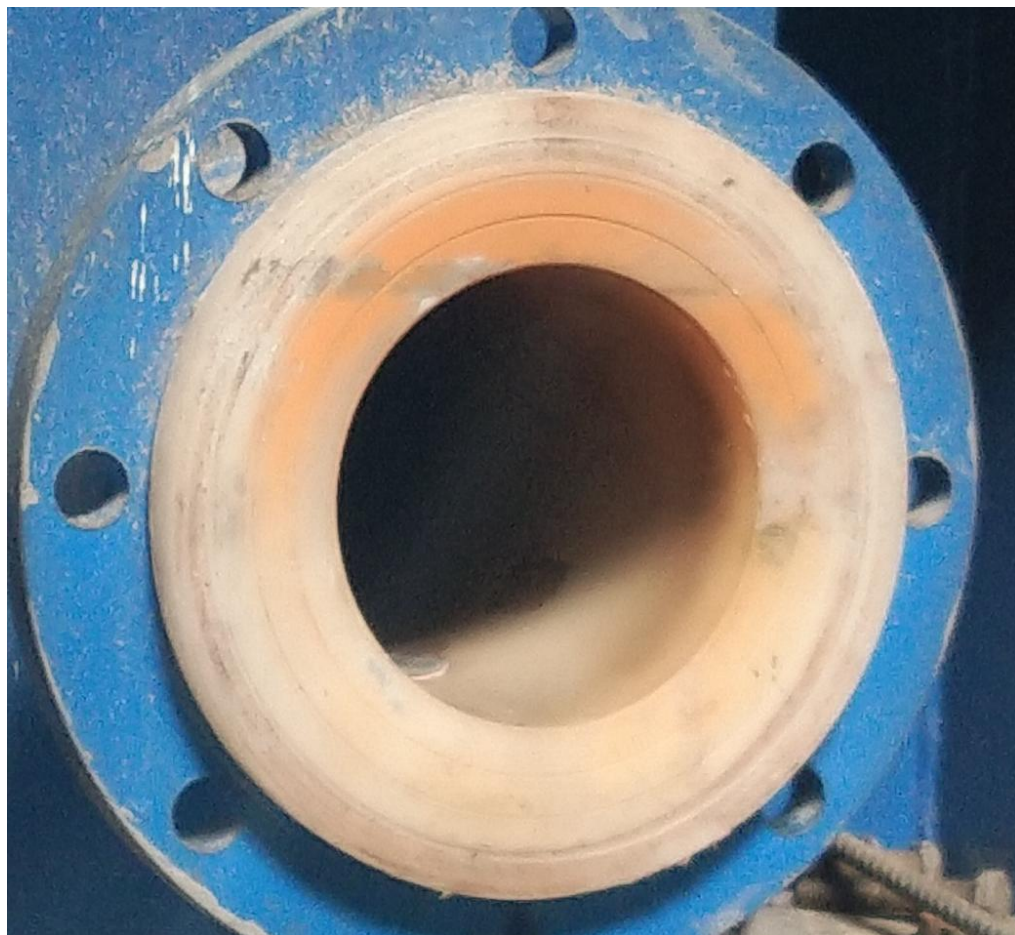
拆解 2#压滤机进料口内衬
