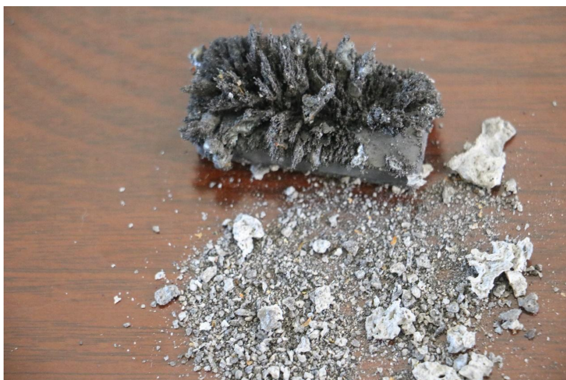
3#压滤机进料管道残留灰迹中存在的铁质残留物
