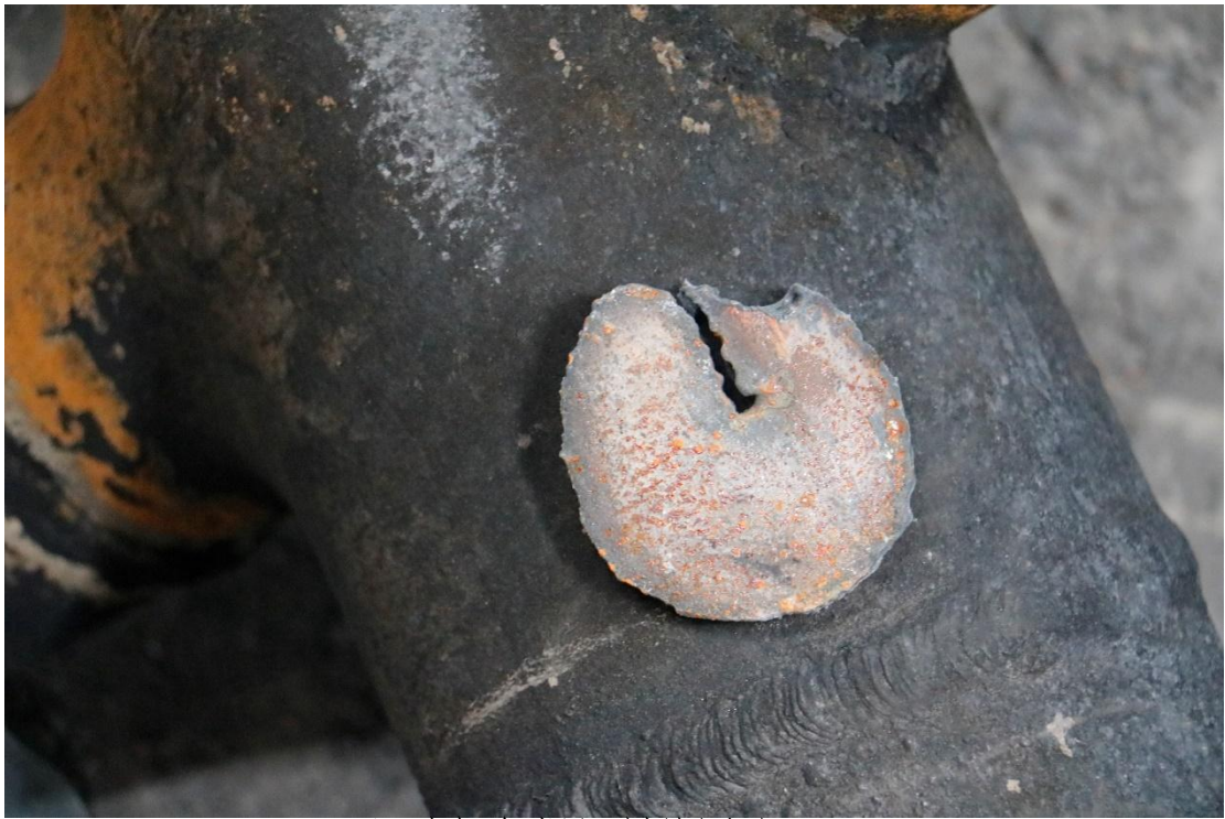
3#压滤机气焊切割的圆孔
